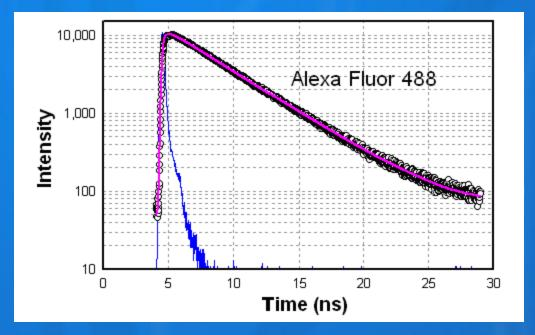
$λ_{Ex}$ : 447-nm Diode Laser Em: 505-nm LP τ = 4.05 ns (water)
